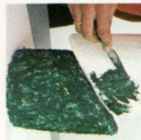
6. Como acabado se utiliza aquí cola de carpintero mezclada con pigmento acrílico y serrín; hay que dar dos capas. Una vez seco, se lija.
