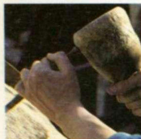
7. Se sigue trabajando con un cincel chato hasta conseguir la forma final, sin profundizar perpendicularmente a la piedra.
