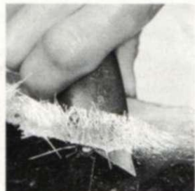
12. Se deja endurecer ligeramente la resina. Con un cuchillo afilado se recorta el «mat» que asome por encima del borde del molde.
