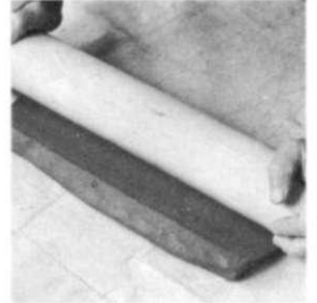
4. Se trabaja la arcilla con un rodillo para uniformar su grosor.
