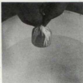
4. La primera capa de yeso se colorea un poco disolviendo un pigmento en el agua de la mezcla.
