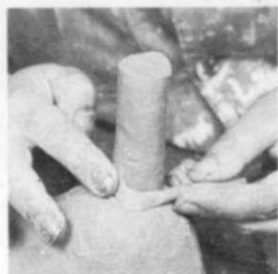
6. En el punto más alto se coloca un rollo de arcilla más delgado, que será el respiradero. Se une por la base con la cubierta, trabajándolo suavemente.
