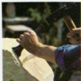
2. Los golpes iniciales debilitan la piedra. Con el martillo, se golpea con fuerza sobre el cincel para cuartear y separar trozos de piedra.
