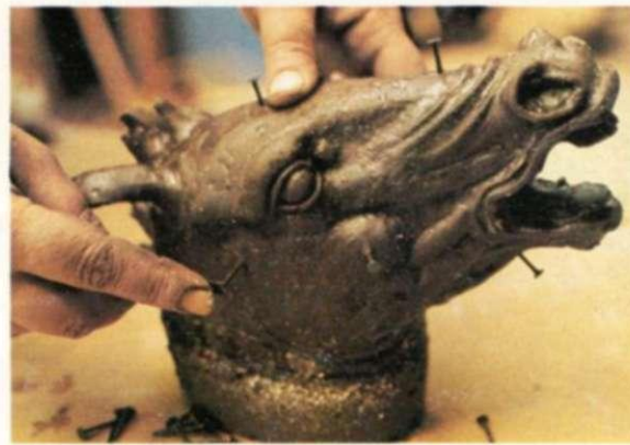
Confeción de un macho en una cera hueca 1. Se apoya la cera sobre una base blanda. Se hace la mezcla de cemento para el macho y se vierte en el interior de aquella.
