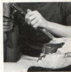
16. Para desmoldear el vaciado se rompe el yeso del molde con un cincel y un martillo. Se pule el vaciado.
