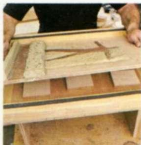
3. Se coloca el modelo en la caja de vacío. Debe quedar por debajo del borde superior de aquélla y despegado unos 3 mm. en todo el contorno.
