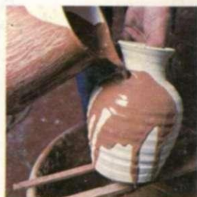
3. Para barnizar el exterior se pone la vasija sobre dos listones apoyados sobre un cubo y se vierte sobre ella el barniz contenido en una jarra o cuenco.
