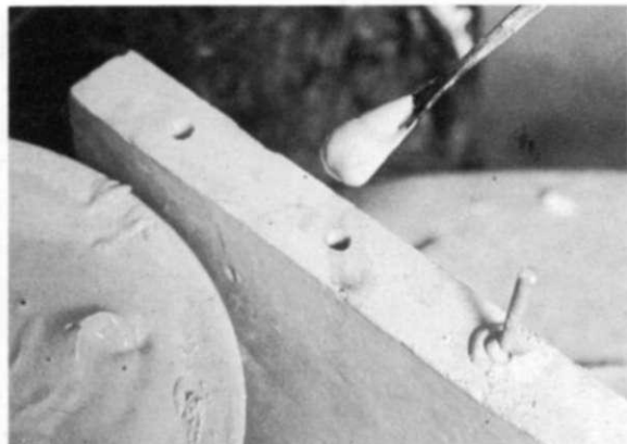
Refuerzo de una junta 1. Se hacen unas perforaciones a lo largo de ambos bordes y se cortan varillas de metal del tamaño adecuado. Los agujeros tienen que estar alineados.
