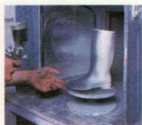
Aspersión Este método necesita un equipo especial—compresor y pistola— y debe hacerse en una cabina también especial que tiene extractor.
