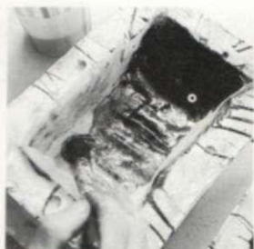
10. Se cataliza resina para estratificados y se aplica a pincel para impregnar el «mat». Se eliminan las burbujas de aire que pueda haber en la resina.
