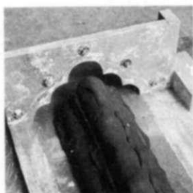
Construcción de una forma lineal 1. El molde consiste en una plantilla metálica apoyada en vertical contra un listón sujeto a un tablero horizontal. Se hace un núcleo de arcilla.
