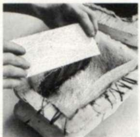
11. Se pone encima y se aprieta contra la resina un «mat» de fibra cortada basto, previamente impregnado en resina.
