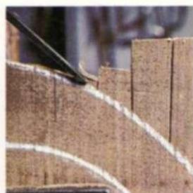
3. Se sujeta el escoplo con el lado plano hacia arriba, para que el lado en ángulo de la boca siga la curva sin ahondar en la madera.
