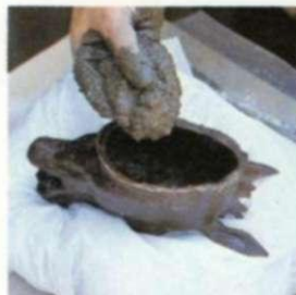
Confeción de un macho en una cera hueca 1. Se apoya la cera sobre una base blanda. Se hace la mezcla de cemento para el macho y se vierte en el interior de aquella.
