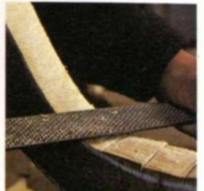
7. Se suaviza la segunda curva con la escofina, como se hizo con la primera. Ahora la forma ya está perfectamente definida.
