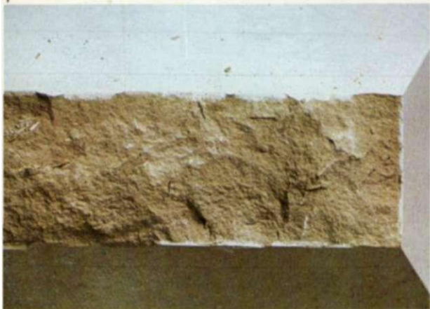
2. Se trabaja gradualmente a lo largo del borde de la piedra, partiendo de uno de los extremos y labrando hacia el centro.
