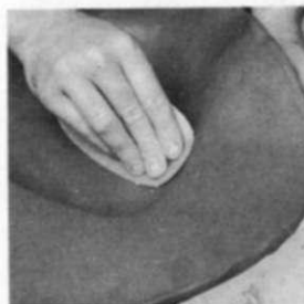
4. Se oprime luego con firmeza y se alisa contra el molde con un trozo de caucho.
