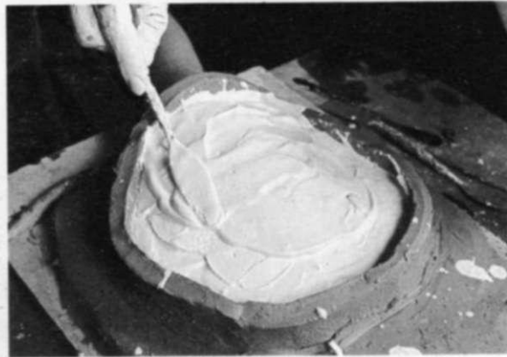
4. Se construye una pared de arcilla alrededor de la cama de arcilla y sobre la muñeca, evitando que queden grietas o desigualdades.
