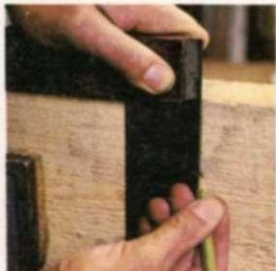
Forma de escuadrar un bloque 1. Se sujeta el bloque en un tornillo de banco y se usa una escuadra para marcar el ángulo recto en un extremo.
