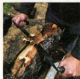
Uso del cuchillo de dos mangos Se agarran con cada una de las manos los mangos de la herramienta y se arrastra ésta a lo largo de la madera para descortezarla a tiras.
