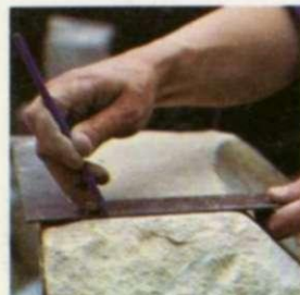
4. Con una punta de trazar se marca un borde de corte bien definido. La punta se guía con una regla o escuadra metálicas mantenida sobre la piedra.
