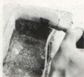
13. Se aplica una tira de «mat» alrededor de una de las secciones del molde asomando la mitad por encima del borde. Se impregna de resina la mitad inferior.
