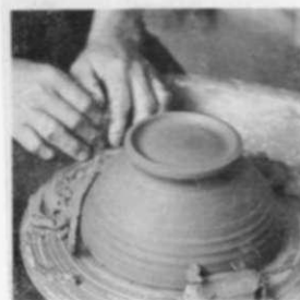
4. Se sigue torneando hasta que la base esté perfecta. Se quitan de la rueda los recortes y se levanta la vasija para cocerla.
