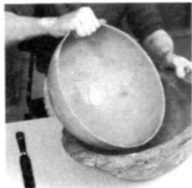
4. Si se sigue este procedimiento se podrá asir el vaciado y sacarlo del molde deslizándolo sobre éste.
