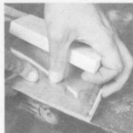
Plegado del metal 1. En el borde del banco de trabajo se coloca un listón de madera, y encima, sobresaliendo, se coloca la chapa de metal.
