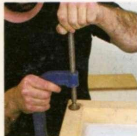
4. Se coloca una placa de poliestireno endurecido sobre la caja, aprisionándolo con un marco de madera que se sujeta junto con la caja con un gato de tornillo.
