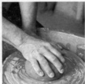
2. Se lanza con fuerza la bola sobre el centro de la rueda del torno, de forma que la base se aplane y se adhiera a aquélla.
