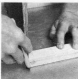
Estratificado 1. Se construye la estructura que se va a estratificar. Se pone sobre una superficie de trabajo metálica encerada y se marca el contorno del borde.
