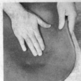
3. Con la palma y los dedos de la mano se va acomodando la arcilla a la forma del molde, con suavidad para no desgarrarla.
