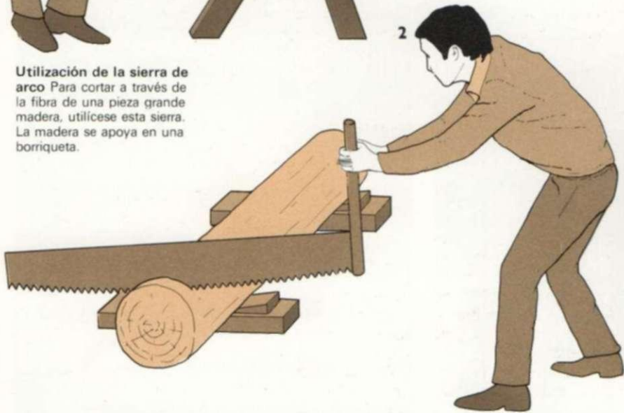
2. Se arrastra la sierra uniformemente por la madera, cortando la fibra a través.
