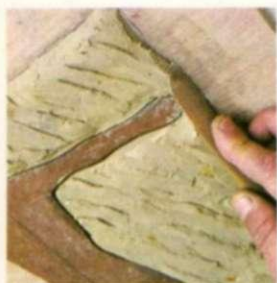
Moldeado de vacío 1. Se hace un modelo en relieve con madera y arcilla. La parte de abajo debe ser absolutamente plana.
