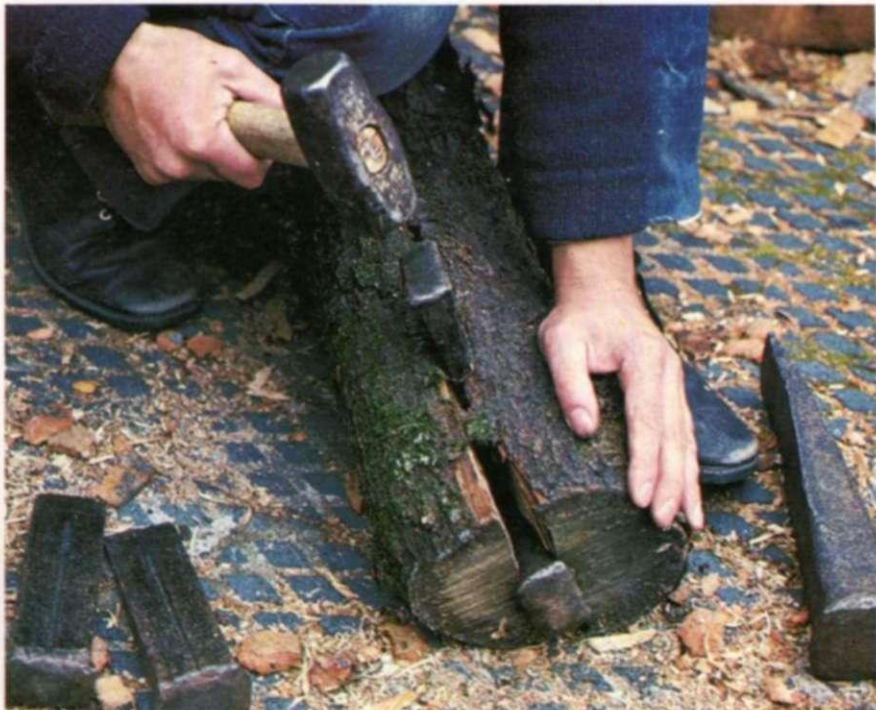
3. Se hincan más profundamente las cuñas para que la madera se vaya abriendo. La primera cuña se va soltando a medida que la segunda va penetrando.
