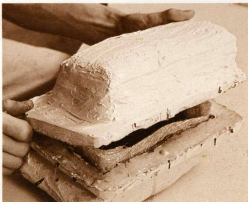
14. Se cuele una porción de resina en esta sección del molde. Se encajan las dos mitades dejando en el interior la tira de «mat».
