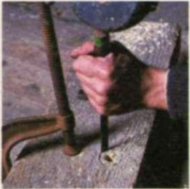
4. Con una gubia pequeña se hacen cortes verticales alrededor del círculo marcado hasta la profundidad necesaria.
