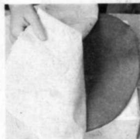
2. Se levantan juntas la tela y la arcilla y se les da la vuelta sobre el molde.
