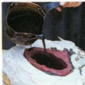
Confección de una cera hueca con el método de vertido y volteado 1. Se cuele una pequeña cantidad de cera fundida en el interior del molde.
