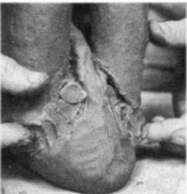
16. Las distintas formas prefabricadas se unen sujetándolas apretadas y se aplica arcilla sobre las juntas para asegurar cada una de las secciones.
