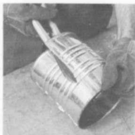
Corte y enderezamiento de una lata de hojalata 1. Se quita la parte de arriba y la de abajo y se corta a lo largo de un lado de la junta con una tijera de hojalatero.
