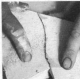
3. Se aprietan firmemente uno contra otro los dos bordes y se les deja por espacio de una hora hasta que se ve que la unión está bastante firme.
