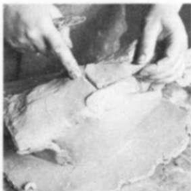
2. Se cubre el modelo con láminas de arcilla de aproximadamente 1.25 cm. de grosor, oprimiendo éstas firmemente alrededor de la forma.
