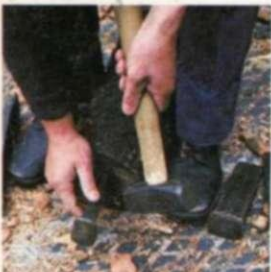
Cachado de la madera 1. Se pone una cuña de metal en el lado serrado de un tronco y se hace entrar en éste golpeándola con un martillo.
