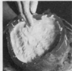
9. Se hace la segunda mitad del molde de la misma forma que se hizo la primera.
