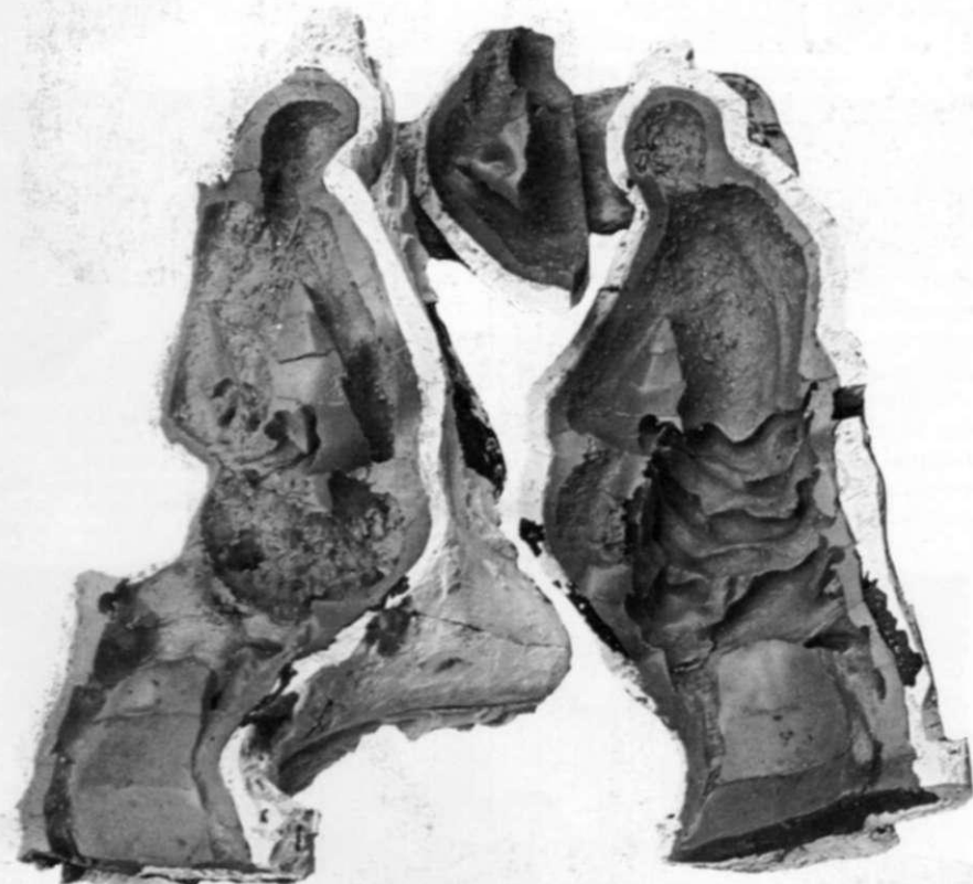
Confección de un molde flexible en piezas Es un proceso similar al de la confección de un molde flexible de una pieza, pero en vez de construir la cubierta de
