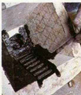
Vaciado en hueco 1. Se hace una lechada de cemento aluminoso y agua y se aplica a pincel en el interior del molde hasta 3 mm de espesor.
