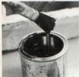
4. Se da una capa de agente separador sobre las capas anteriores, con lo que el molde queda preparado para el vaciado.
