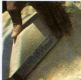
9. Para suprimir las marcas dejadas por el cincel se utiliza una escofina, que en las piedras blandas puede usarse también como herramienta para la talla.
