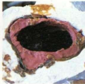
2. Se le da vueltas al molde y se tira la cera sobrante. Se repite este proceso hasta conseguir una capa uniforme.
