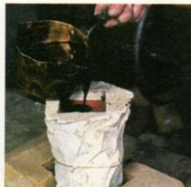
2. En una cacerola se funde la cera suficiente para llenar el molde, en el que se cuele lentamente.
