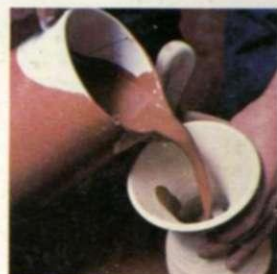
Vertido 1. Para cubrir el interior de una vasija puede llenarse de barniz hasta el borde.
