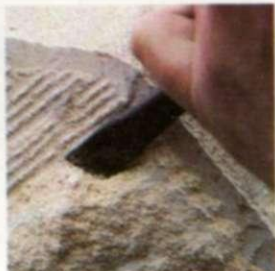
6. Se talla la piedra con una uña golpeada con un mazo de palo santo, lo que deja sobre la superficie marcas en forma de rayas paralelas.
