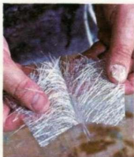
2. Se corta en pequeños trozos un «mat» de fibra de vidrio y cada trozo se separa en dos capas delgadas.
