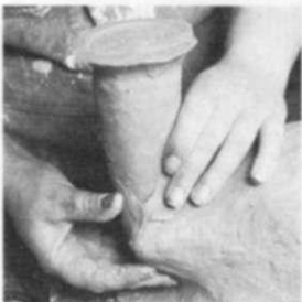
5. En el punto más bajo de la cubierta de arcilla se coloca verticalmente un grueso rollo de este material, que será el bebedero.
