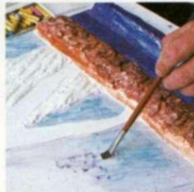
6. El plástico moldeado al vacío puede colorearse de diversas maneras. Aquí se está haciendo con pasteles al óleo y trementina.
