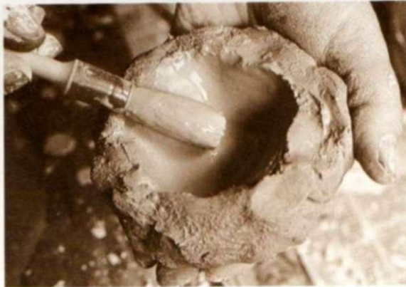
12. Se sigue poniendo yeso hasta formar una capa gruesa y uniforme. Debe ser particularmente fuerte en las juntas, contra la pared de arcilla.
