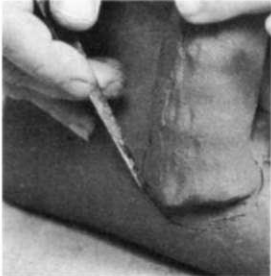
11. Se sostienen las piezas en lo que será su lugar definitivo y se marcan las juntas con un cuchillo.
