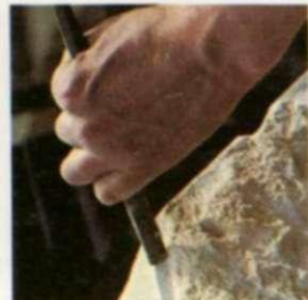
5. Con un cincel chato de wolframio se agranda la marca de la punta. Se redefine bien el borde y se trabaja el plano de arriba abajo.
