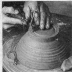
2. Manteniendo en la parte interior de la base un utensilio metálico, se hace un pie en forma de anillo.
