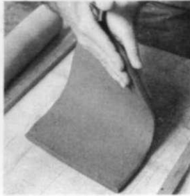
6. Se le da la vuelta a la placa y se pasa otra vez el rodillo.
