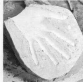
7. Se quita la pared de arcilla y se comprueba que la mano puede retirarse fácilmente del molde.
