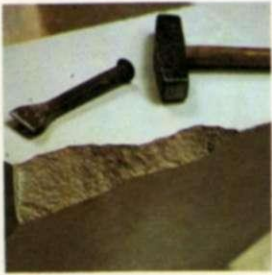
Desbaste con cincel 1. Para esta labor se necesita un cincel de desbastar y un martillo de cantero.
