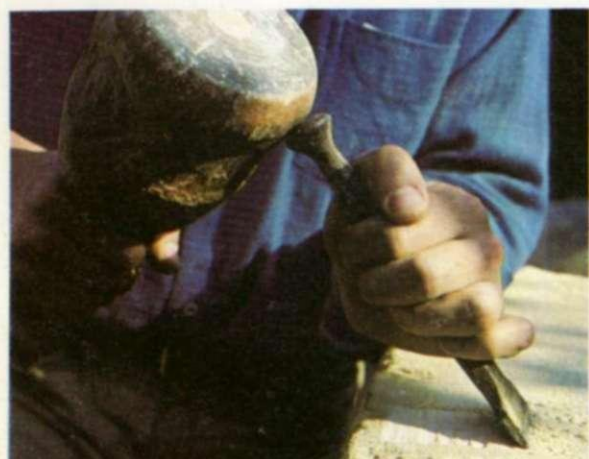
7. Se sigue trabajando con un cincel chato hasta conseguir la forma final, sin profundizar perpendicularmente a la piedra.
