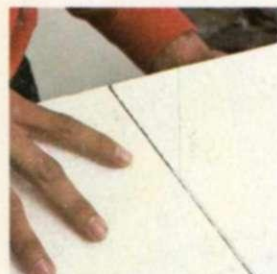
Corte y unión del poliestireno expandido 1. Marcar el bloque con un rotulador y cortar a lo largo de la marca con un cortador de alambre caliente.
