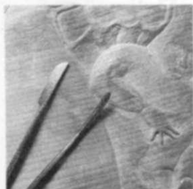
Colas de ratón 1. Son herramientas pequeñas con cabezas limadoras que existen en diversas formas y con mangos de sección rectangular o redondeada.
