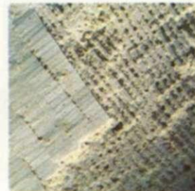
8. Para quitar las marcas de la uña y para definir la forma acabada de la talla se usa el cincel chato.
