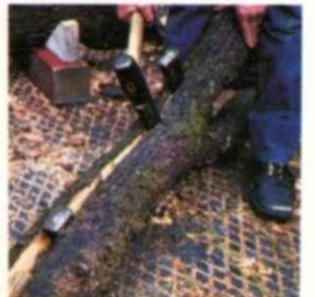
4. Se toma entonces la primera cuña y se coloca detrás de la segunda. Se golpea con el martillo para alargar la raja.
