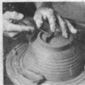
3. Con un utensilio ancho se rebaja la arcilla en el centro de la base.
