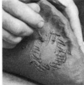
12. La superficie de unión se raya con cuchillo para facilitar así la adhesión de las distintas piezas.
