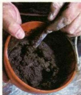
3. Se hace una mezcla de hormigón, bastante espesa, utilizando partes iguales de cemento y de arena blanca de cuarzo puro.
