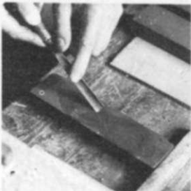
3. La gubia se afila imprimiéndole el ritmo de un movimiento en forma de
