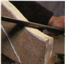
5. Se da la vuelta a la escofina y se emplea el lado redondeado para trabajar sobre las superficies cóncavas.
