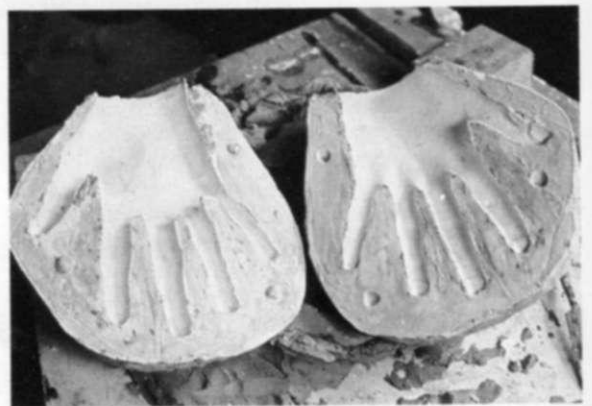
8. Se vuelven juntos mano y molde. Se vuelve a hacer la pared de arcilla y se tallan fijas de centrado en el yeso. Se sella la junta del molde con lechada de arcilla.
