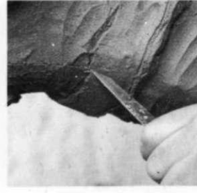
3. Se corta de arriba abajo por lo que será la línea de junta previamente marcada, en dos piezas si es posible, y se separan de la armadura.
