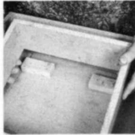
Vaciado sólido 1. Se construye un molde o cajón de moldeo adecuado. A las superficies interiores se les aplica un desmoldeador.
