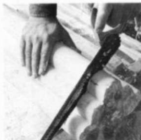
Unión de formas hechas en yeso 1. Con un serrucho multi-uso se cortan las distintas secciones al mismo tamaño.
