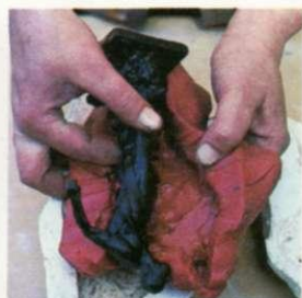
3. Se espera a que solidifique la cera y se desmonta la cubierta. Se libera la figura de cera retirando con cuidado el molde flexible.
