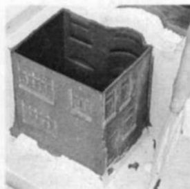
6. Se desmonta con cuidado el molde para sacar el vaciado, que es muy delgado y puede pandearse si no está suficientemente seco.
