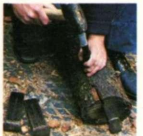
5. Se repite el proceso hasta que el tronco se separe en dos piezas. Con un destal se cortan las fibras que todavía las mantienen unidas.
