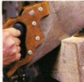
2. Se sostiene firmemente la hoja de una sierra de trozar con el pulgar de la mano que no maneja la sierra. Se arrastra toda la longitud de la sierra a través de la madera.
