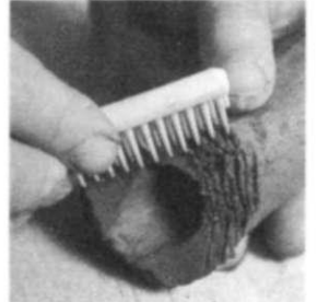
13. Se rayan asimismo todas las demás superficies que vayan a unirse, para lo que es muy útil un peine de plástico.
