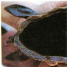
3. Esta es la cera hueca terminada. Debe tener el grosor suficiente para soportar todo el proceso que lleva al vaciado.
