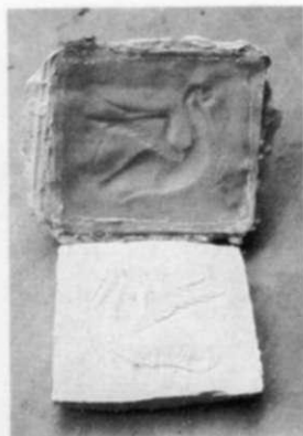
Confección de un molde de látex El látex se aplica a pincel sobre el original en sucesivas capas delgadas. Hay que dejar secar cada una de ellas, hasta que se haga una película transparente, antes de aplicar la siguiente. El látex es muy flexible, por lo que necesita una cubierta de yeso, que hay que hacerla antes de retirar el molde del original.
