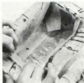
9. Cuando todavía está pegajoso el gel, se le pone encima un «mat» fino, oprimiéndolo contra aquél en toda la superficie del molde.
