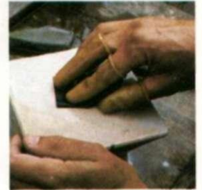
4. Por último, para el pulimento final de la superficie se emplea papel de carborundo.
