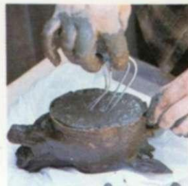
2. En el centro del macho se inserta alambre galvanizado, previamente medido y dado forma.
