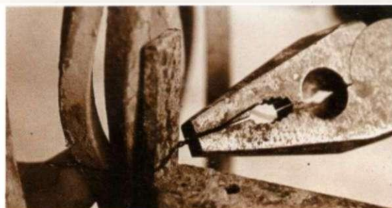
2. La armadura se sujeta fuertemente con alambre de acero al soporte de hierro.
