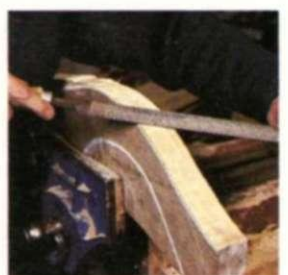
4. Se alisa la superficie de corte con una escofina, utilizando el lado plano de la misma sobre las curvas convexas.
