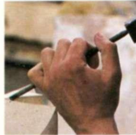
Acabado 1. Para el delicado trabajo de talla y alisado final de la piedra, así como para el aguzado de los ángulos, se emplean cinceles finos.
