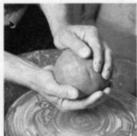
Modelado en torno 1. Se trabaja con ambas manos un terrón de arcilla hasta conseguir una bola consistente y suave.
