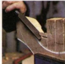
6. Cuando se completa un lado de la forma, se da la vuelta a la madera en el tornillo y se repite el proceso sobre el otro lado.
