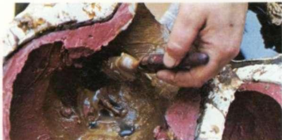
Confección de una cera hueca con el método de vertido y volteado 1. Se cuele una pequeña cantidad de cera fundida en el interior del molde.
