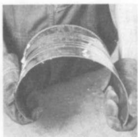
2. Con las manos protegidas por guantes se agarra cada lado del metal y se tira hacia afuera para que se enderece.
