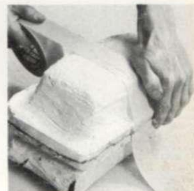
15. El molde se sujeta unido con una cinta adhesiva y se sellan las juntas. Se le da vueltas para que la resina impregne el resto del «mat», y se deja endurecer.
