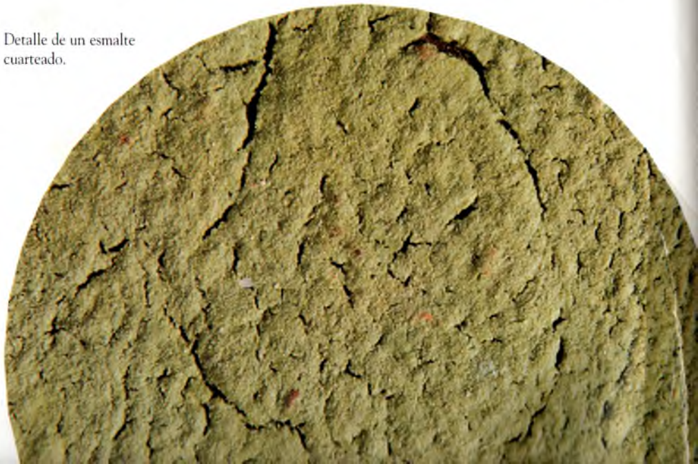
Detalle del picado en una cerámica cocida a su temperatura, pero que fue horneada con el esmalte recién aplicado.
