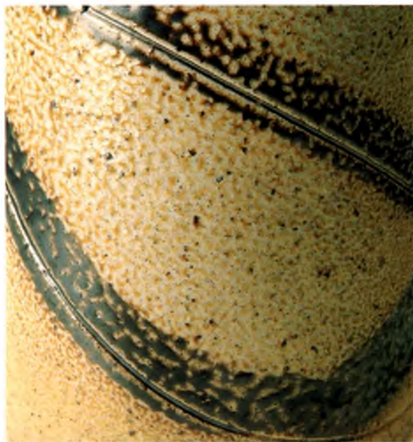
Detalle ampliado de la textura típica, arrugada, de piel de naranja del esmalte salino.
