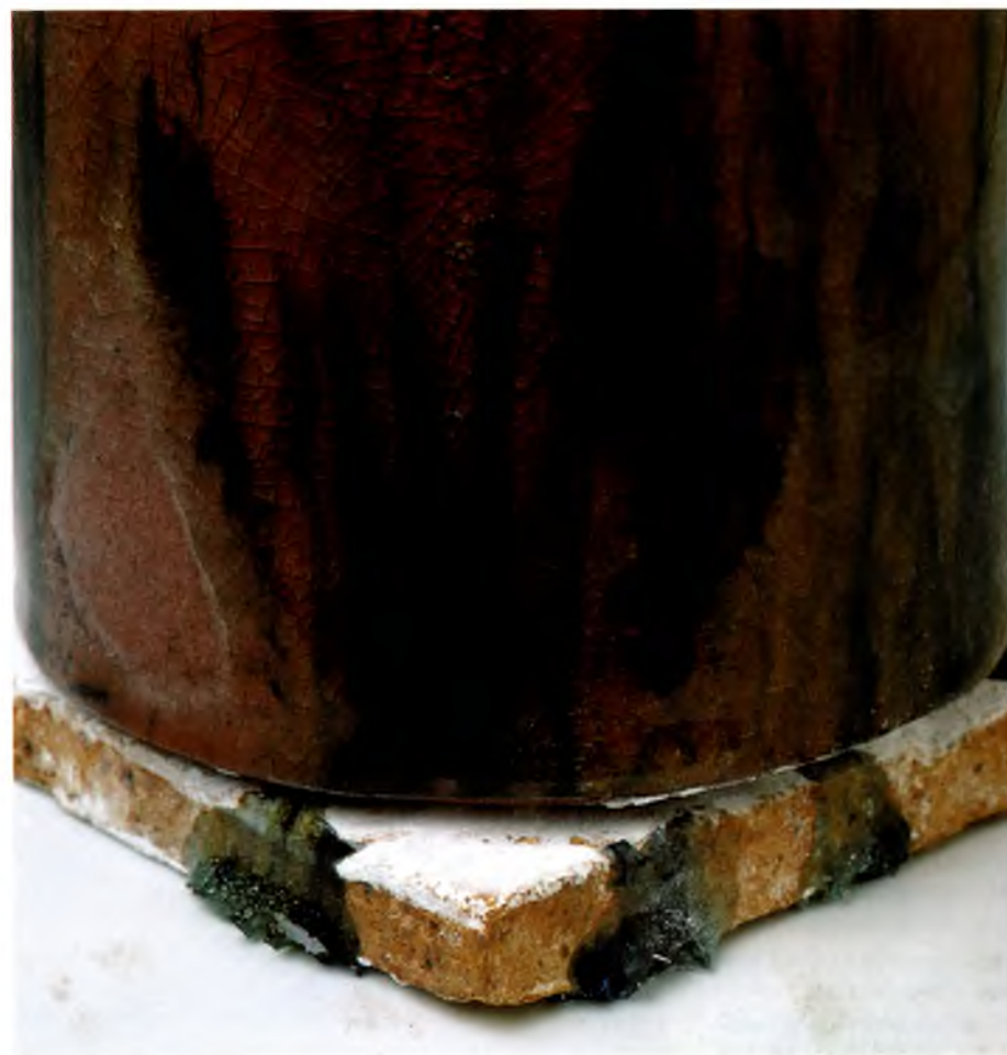
Pote de arcilla ferruginosa torneada. La colocación de la pieza sobre la placa cubierta con alúmina evitó que se pegara. Obsérvense el chorreo sobre las paredes y la placa de soporte y también la zona en la que casi no hay esmalte (parte inferior izquierda).
