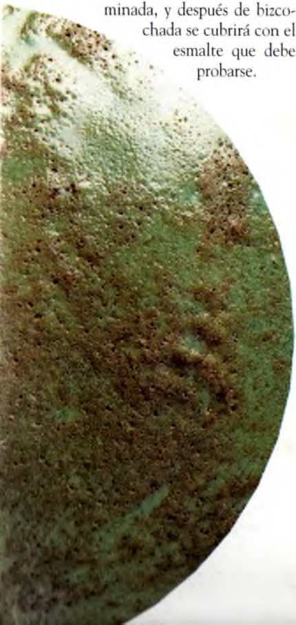
Detalle del picado en una cerámica cocida a su temperatura, pero que fue horneada con el esmalte recién aplicado.
