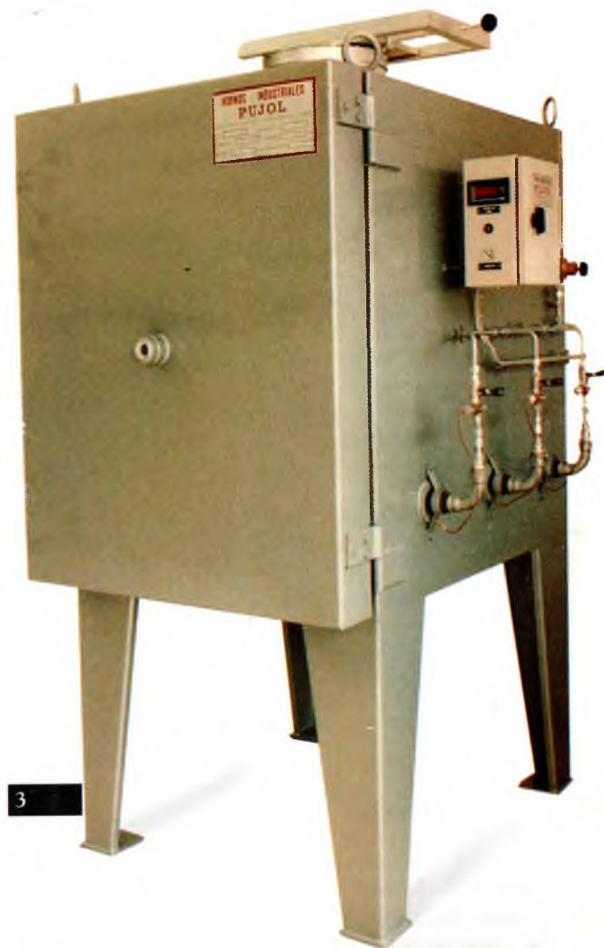
3. Horno de gas de tiro superior provisto de seis quemadores, colocados de tres en tres en las paredes laterales. Alimentado con gas butano o propano, pueden realizarse cocciones con atmósferas oxidantes y reductoras, llegando a temperaturas de 1.300 °C (2.372 °F) y cocción a fuego directo.
