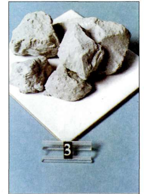
Arcillas de gres: En su composición interviene la suficiente cantidad de feldespato para que éste actúe como fundente y las haga vitrificar hacia los 1.300 grados. Cocidas, poseen gran plasticidad y mínima absorción, presentando tonos grises o cremas.
